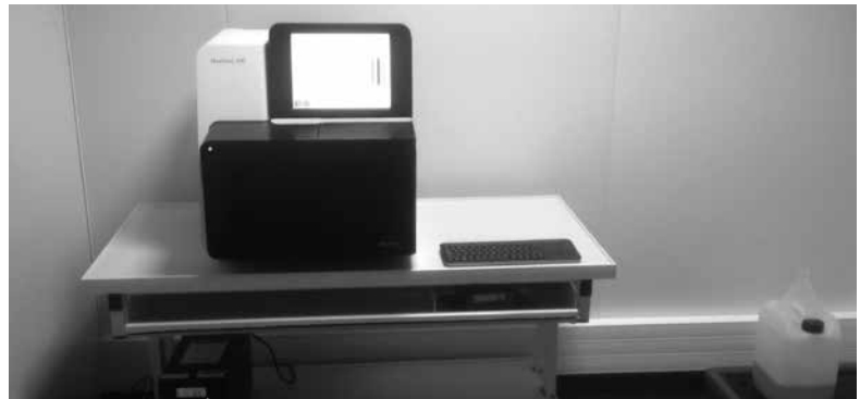
Pièce du séquenceur : Équipée d'un NextSeq500 d'Illumina capable de séquençer jusqu'à 10 patients par semaine (soit 20 exomes et 10 transcriptomes)
